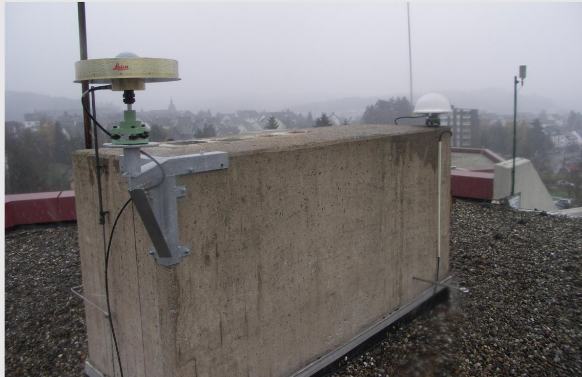
Betrieb einer Wechselreferenzstationsantenne für die Dauer einer Woche vor und nach dem Antennenwechsel.
